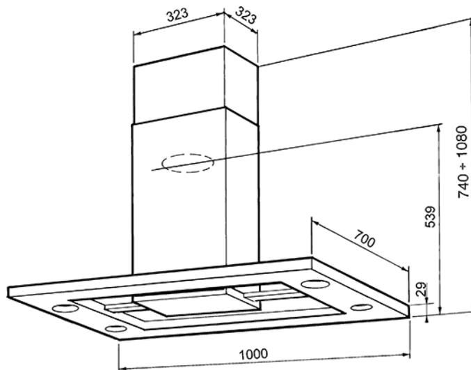
• ЭСТЕТИКА и УПРАВЛЕНИЕ: • Нержавеющая сталь + стекло • Электронное управление • LED освещение (4 x 2 Вт) • ФУНКЦИИ/ОПЦИИ: • 1 мотор • Максимальная мощность: 691 м³/ч • 3 скорости + интенсивный режим (10 мин.) • Уровень шума (на 1 скорости): 54 дБ(А) • 1 жироулавливающий фильтр из нержавеющей стали • Диаметр воздуховода: 150 мм • Обратный клапан •
