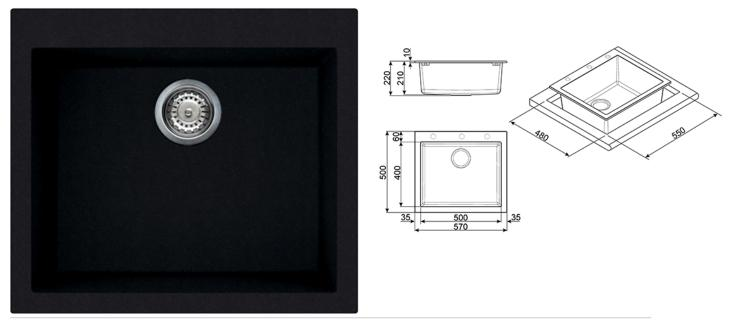
• Врезная мойка • Цвет: черный • Общий размер: 570х500 мм • Размеры чаши: 500х400 мм • Глубина чаши: 210 мм • Размеры выреза: 550х480 мм • Установка в базу 60 см • Комплектация: • Корзинчатый вентиль 3" 1/2, фиксирующие зажимы, сифон
